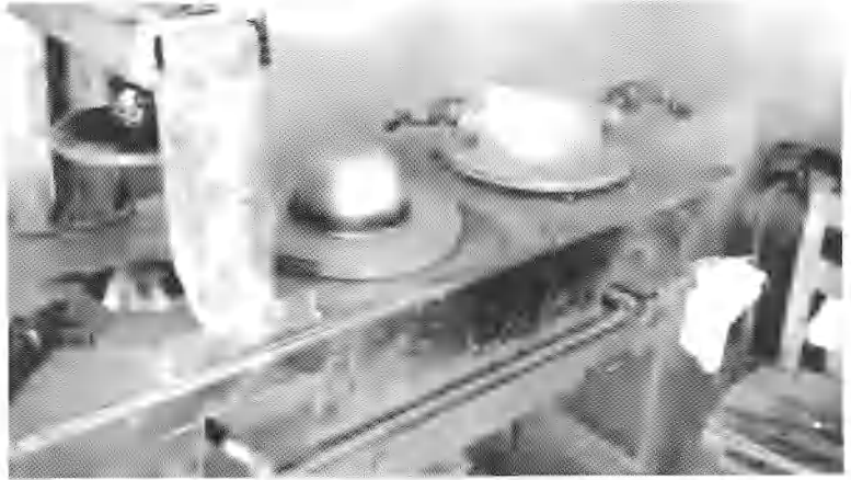
المكبس الحراري المستخد لكبس طواقي الخوص، جامع المادة: حسام محسب- منورس - الفيوم ٢٠٠٩/٨/١١
